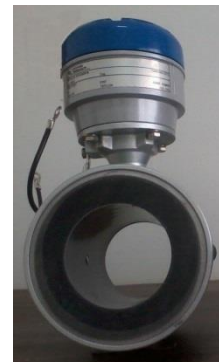
Tube Sensor tipo Wafer Apenas um tubo vazio
