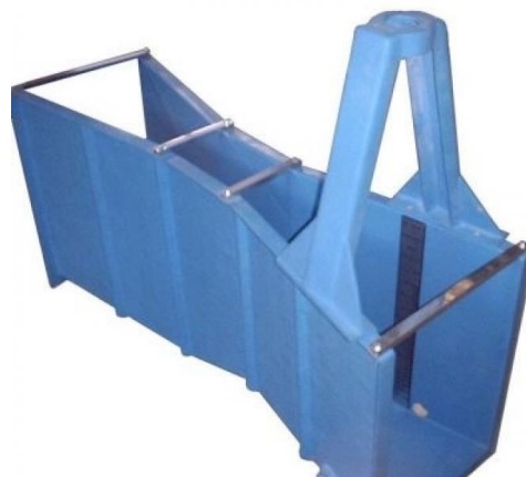
Foto3: Calha Parshall com suporte para medidor ultrassônico
