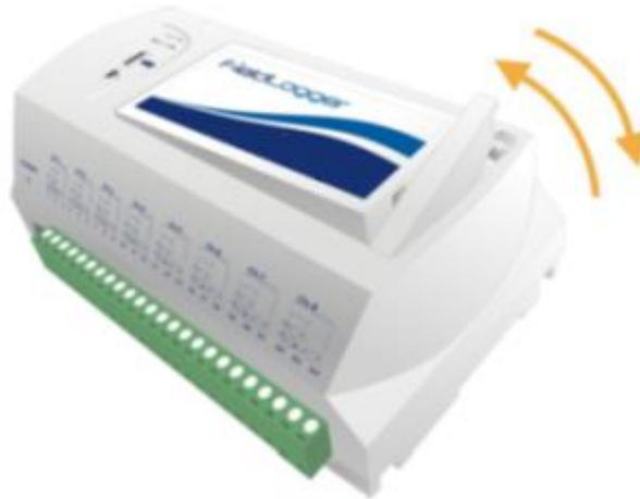
Fig. 08 – Retirando e instalando a tampa frontal do *FieldLogger*
